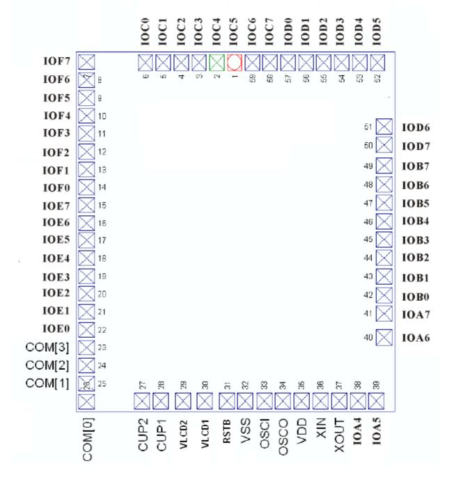
注: 采用 OTP 芯片做样机制作 PCB 时,请将如下烧碌脚 RSTB, VSS, VDD, XOUT, IOA5, IOA6 共 6 根脚预留出来,以便烧碌程序用。
