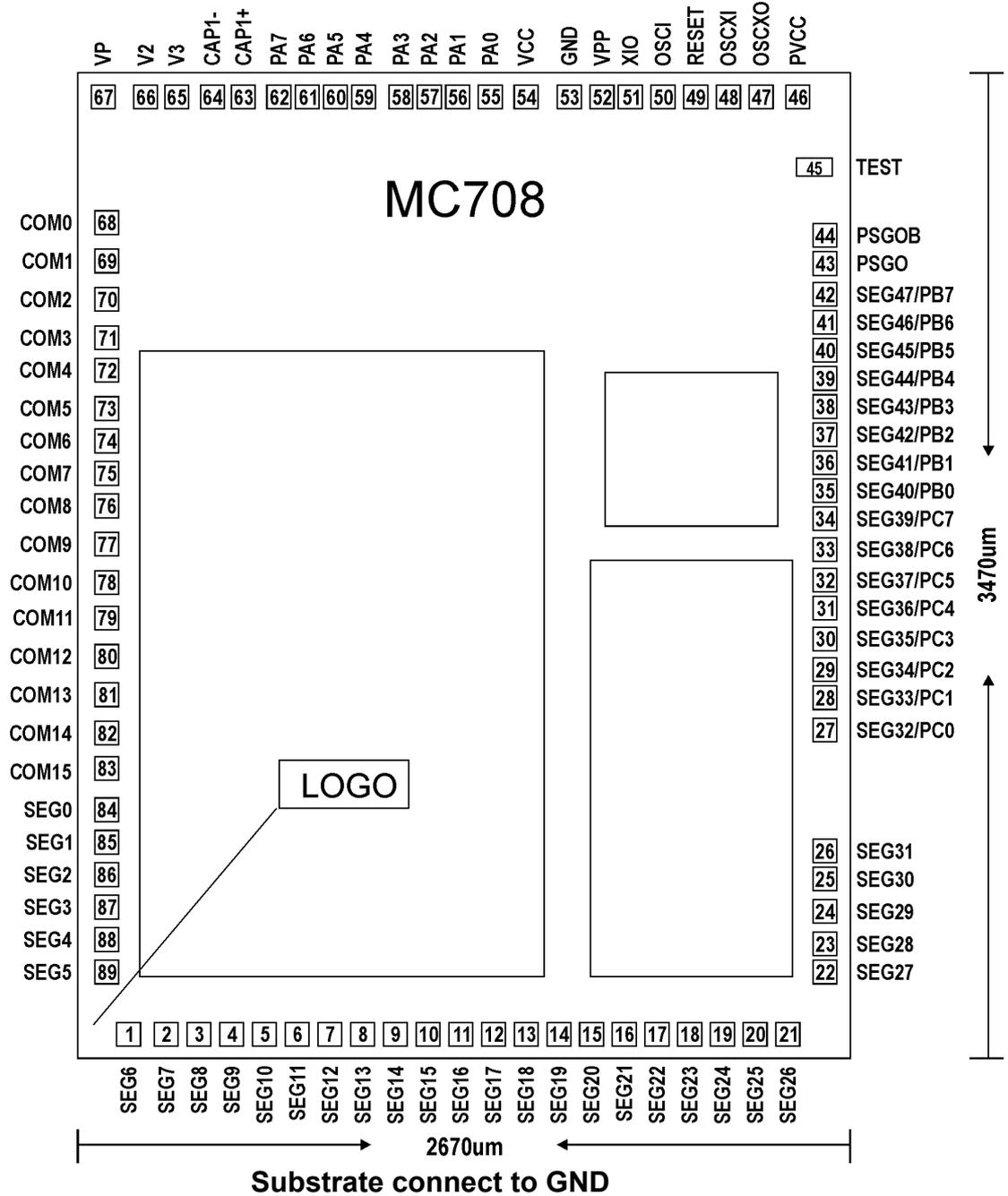
※注： OTP 需要烧录的 VPP, GND, VCC, TEST, REST, COM1, COM2, COM3, COM4, COM5 共 10 根脚在 PCB 上要有焊盘或测试点以供烧录。
